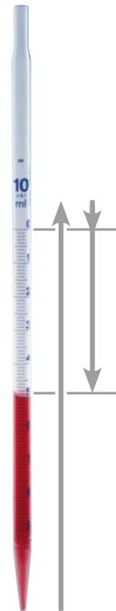
Bei der Verwendung von Messpipetten des Typs 3 (Nullpunkt oben) muss der Meniskus zunächst auf den Nullpunkt eingestellt werden. Anschließend wird die Flüssigkeit bis kurz über das gewünschte Teilvolumen abgelassen. Dann wird der Meniskus ein zweites Mal auf das gewünschte Volumen eingestellt.
