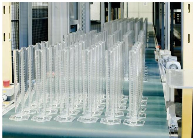
Eine Besonderheit stellt der Fluorkunststoff PFA dar. Dieses Fluorkunststoffcopolymer besitzt zwar nicht die ausgezeichnete Transparenz wie PMP, verfügt aber über die bei weitem beste Chemikalien- und Temperaturbeständigkeit. Ebenfalls bietet es bei richtiger Verarbeitung eine hervorragende Formstabilität nach dem Produktionsprozess und kann daher zur Herstellung von Messkolben der Klasse A verwendet werden.
