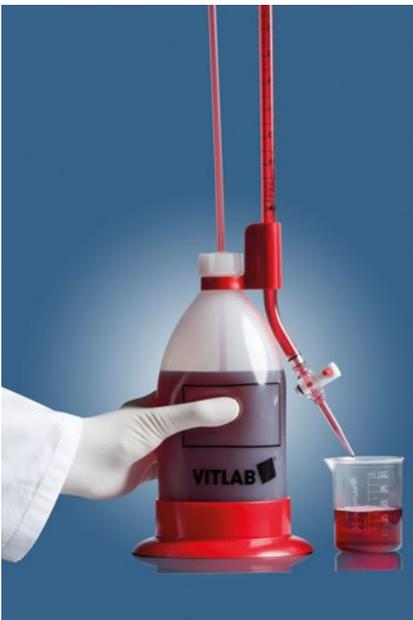
Bürette mit Maßlösung spülen und so ausrichten, dass das Bürettenrohr senkrecht steht.
